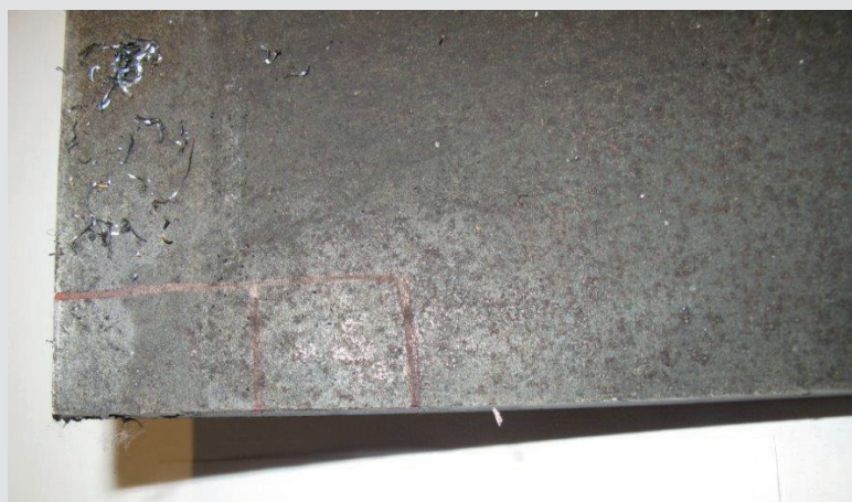
Bild 2: Aufsicht und Querschliff der Stahloberfläche nach der Einförmung bei der HFI-Rohrherstellung am Beispiel eines API 5L X70 bzw. L485
