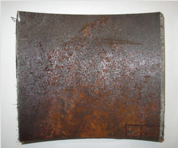
Bild 3: Aufsicht und Querschliff der Stahl Oberfläche nach Lagerung des Rohres im Freien
