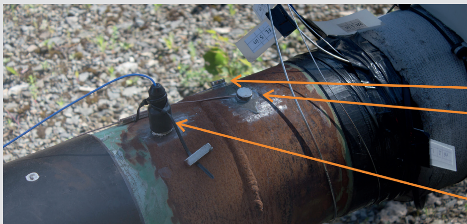
Bild 5: Anbringung der Körperschallsensoren
