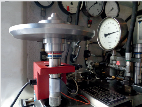
Bild 1: Die Druckwaage für den Stresstest – robust, zuverlässig und genau
