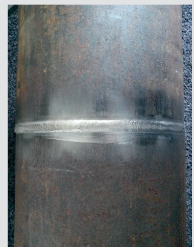
Bild 2: Herstellung der Rundnaht mittels Wolfram-Inertgas-Schweißen (WIG) bei der FW-FERNWÄRME-TECHNIK GmbH und fertige Rundnaht
