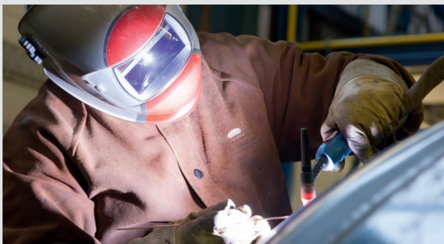
Bild 2: Herstellung der Rundnaht mittels Wolfram-Inertgas-Schweißen (WIG) bei der FW-FERNWÄRME-TECHNIK GmbH und fertige Rundnaht
