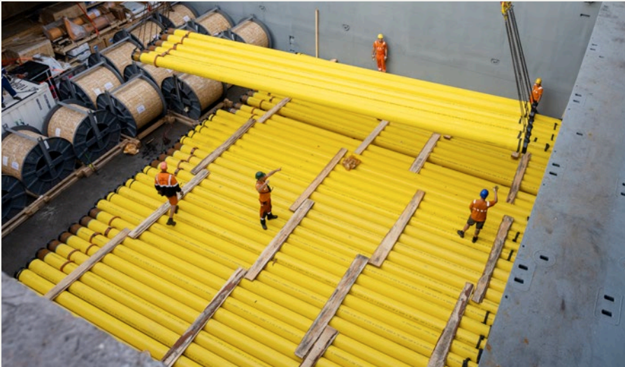
Oben: Die Herstellung der Rohre erfordert die Einhaltung engster Fertigungstoleranzen. Links: Nils Schmidt überwachte das fachgerechte Handling beim Einladen und die sichere Lagerung der rund 650 HFI-geschweißten Zap-Lok™-Rohre im Schiff.
